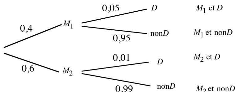
Fig. 26 : Diagramme probabilisé de la fabrication des boulons par deux machines
